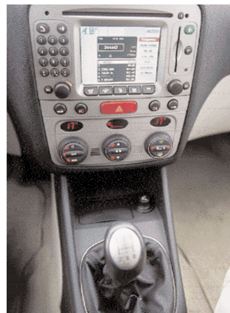
Sistem Connect v sebi združuje radio, potovalni računalnik, navigacijo in telefon.
