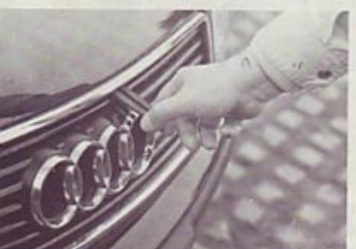
Po Mercedesovem zgledu: ročica za odpiranje prednjega pokrova
