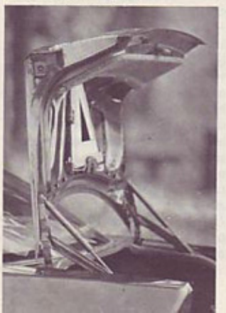
Prtljažni pokrov: navpično odpiranje in vstran zložljiva podporna paralelograma
