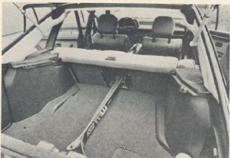
Luknja, ki jo razkrīje poklopec (tega je zelo težko znova namestiti) v zadnjem naslonjalu, se razvleče v vodotesen tulec iz mehke plastike, v katerem je prostora za štiri pare smučī. Trik, ki prizaneso s prtlačnikom na strehi
