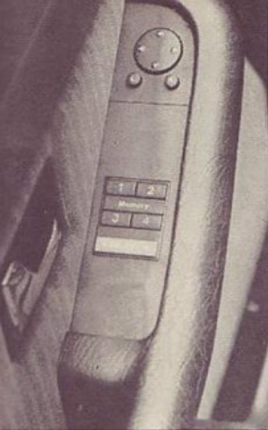
Avant quattro: stikala za zunanji ogledali in programiranje voznikovega sedeza (na voznikovih vratih)
