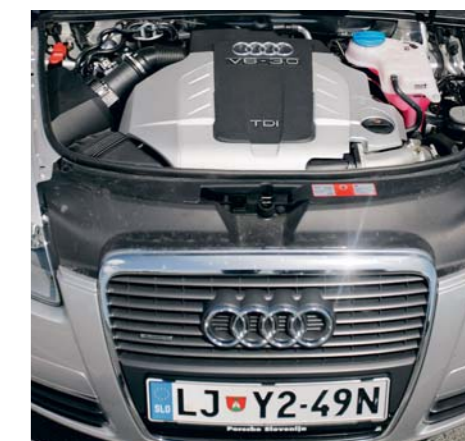
▲ Motor družine TDI, 3 litri prostornine, šest valjev: razen hladen v prostem teku, ko ni posebej uglasjen, je odlični proizvajalci veliko navora, ki hitro naraste do lepih 450 njutonmetrov, kar tudi ob hidravlični sklopki (samodejni menjalnik!) omogoča zelo hitra premikanja. Še najbolj se seveda izkaže na hitrih avtomobilskih cestah.
