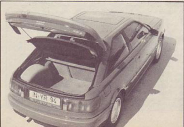
Zadnja vrata so (s šipo vred) hkrati tudi prtljažni pokrov, polica pod njimi ni obešena, ampak samostojno dvizna
