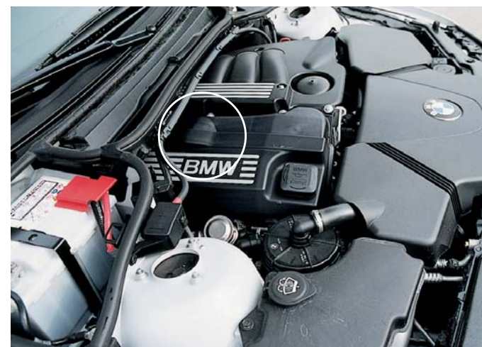
Motor s sistemom Valvetronic: manjša poraba goriva, (še vedno) veselje do vrtenja, a rahlo slabša odzivnost na trzljaje stopalke plina. V krogu označena izboklina pokriva elektromotor sistema Valvetronic.
