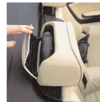
Varnostna loka, skrita v vzglavnikih, se po potrebi (prevračanje) sprožita v nekaj tisočinkah sekunde.
