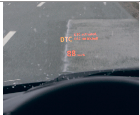
▲ HUD (Head-up display): odličen pripomoček-tudi s stališča aktivne varnosti (lažje nadziranje podatkov, kot če so v merilnikih.)
