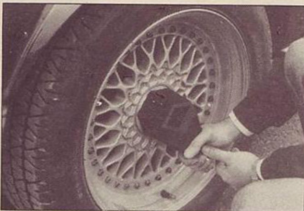
M 635 CSI: tridelno platišče z matico na sredini
