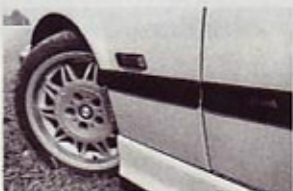
M3: velika platišča, nizkopresečne gume, natančni karoserijski spoji
