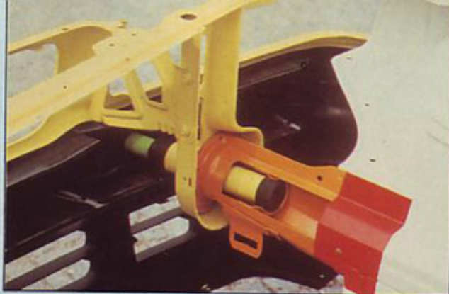
Prednji odbijač: teleskopska zasnova za prestrzevanje udarcev.
