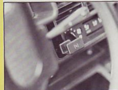
Slaba točka: opletajoč vzvod ročnega čoka.
