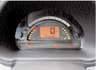
Merilniki: nenavadna postavitev in oblika; števec vrtljajev nima rdečega polja, elektronika prekine vžig pri 6400 vrtljajih v minuti.
