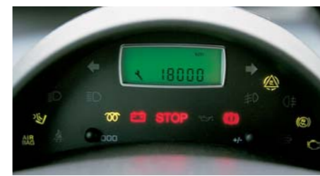
Kontrolne lučke in informacijski zaslon: za volanskim obročem in pomičen z njim.
