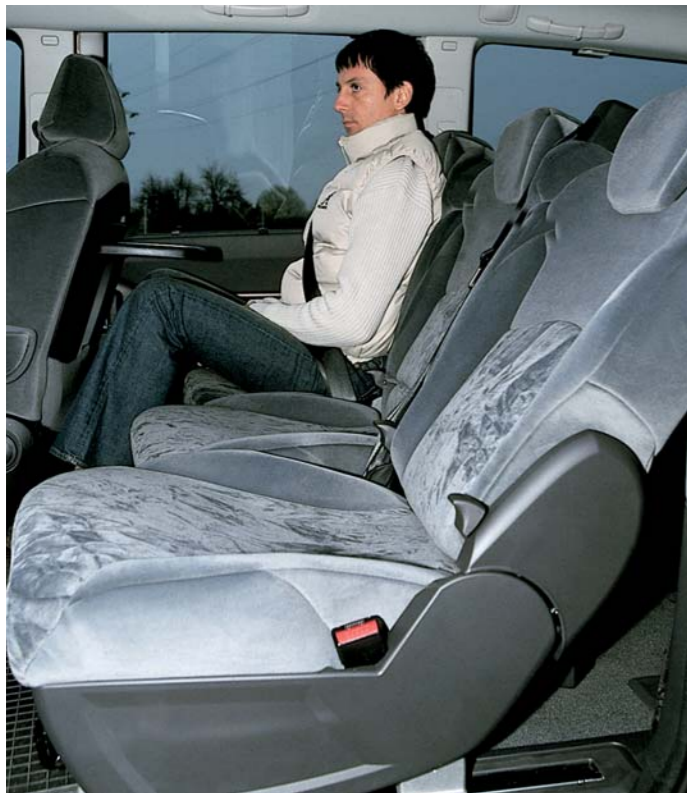
Prilagodljivost trije sedeži v drugi vrsti: vsakemu posebej lahko nastavimo odklon po dolžini in naklon naslonjala
