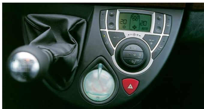
Osrednji del armaturne plošče: na izbuljenem delu so prestavna ročica, mali predalček in klimatizacijske komande.
