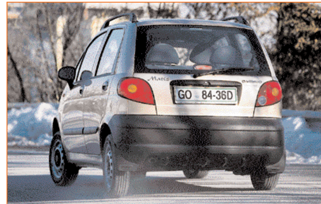
Registrska tablica se je premaknila z odbijača na pokrov prtljažnika, ki je obogaten tudi s kljuko za dviganje pokrova (odpiranje pri Matizu S je možno zgolj s ključem).
