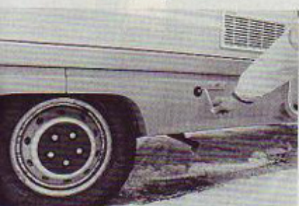
Izolirana in ogrevana posoda za odpadno vodo, s štirioglatim ključem ventila za izpust.
