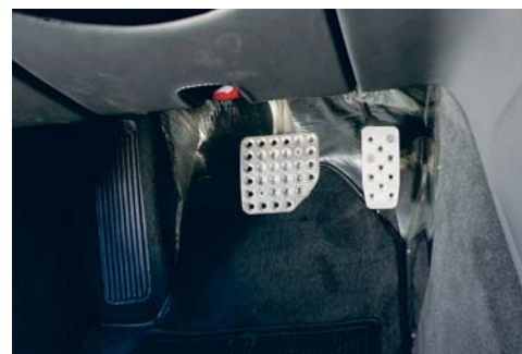
▲ Da se desna noga ne zatika, poskrbi aluminijasta ploščica ob stopalki, za neboleče koleno skrbi posebna mehka opora.
