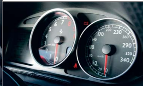
▲ 612 ima le dva merilnika, za vse druge podatke poskrbi večopravilni prikazovalnik.
