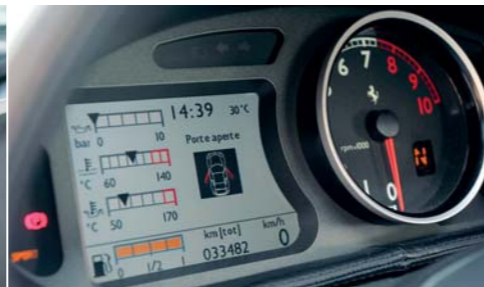
▲ 612 ima le dva merilnika, za vse druge podatke poskrbi večopravilni prikazovalnik.
