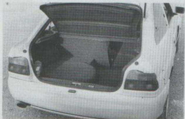
Na račun pogona je v prtljajniku bolj malo prostora, omejuje ga tudi zasilno rezervno kolo
