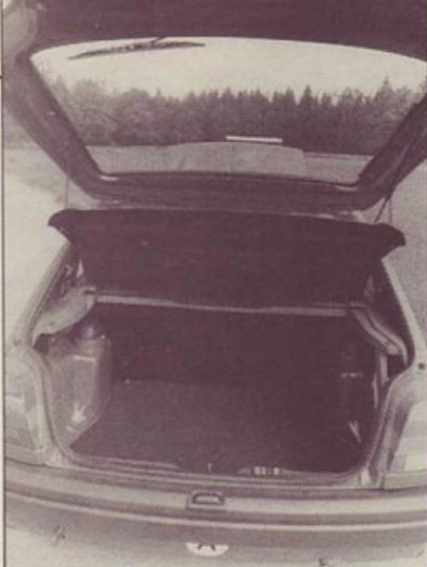
Prtljažnik: deljivo povečljiv in lahko dostopen, toda vrata k njemu je moč odpreti le s ključem
