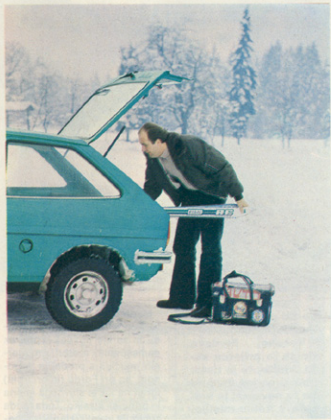
Zadnja vrata podprta teleskopski opori in se odpirajo od vrha do tal. Ob prekucenju zadnji klopi je v fiesti prostor tudi za daljše kose prtljage
