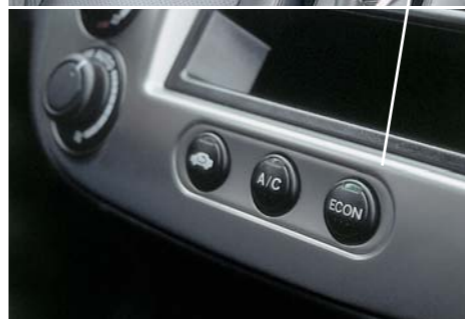
S stikalom ECON vklopate sistem Auto Stop, ki med mirovanjem vozila ugasne bencinski motor. Skozi reže v črni škatlici se hladi 144-voltna baterija in pamet sistema IMA.
