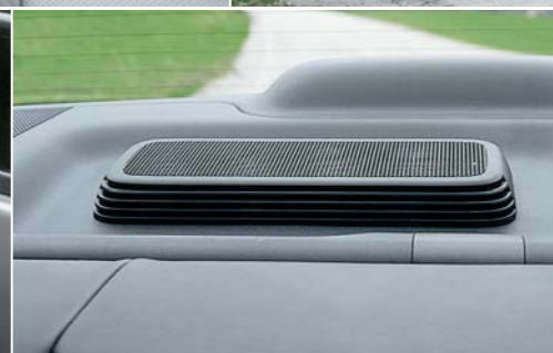
S stikalom ECON vklopate sistem Auto Stop, ki med mirovanjem vozila ugasne bencinski motor. Skozi reže v črni škatlici se hladi 144-voltna baterija in pamet sistema IMA.
