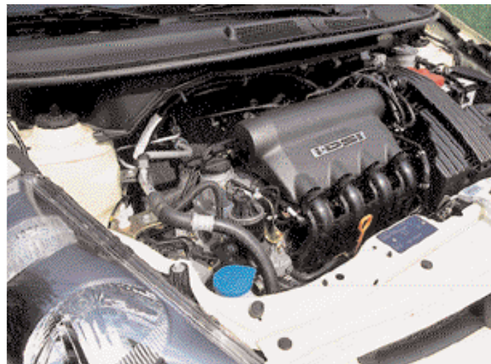
Motor: poskočen z dvema vžigalnima svečkama (DSi) in hru-pen nad 4000 vrt/min.
