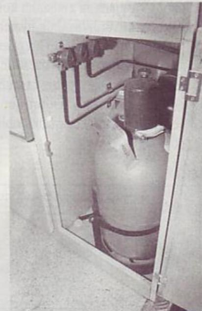
Dvakrat po 5 kg plina je v jeklenkah, ki so spravljeni v zaprtem prostoru v zadnjem delu bivalnika tik ob zadnjih vratih.
