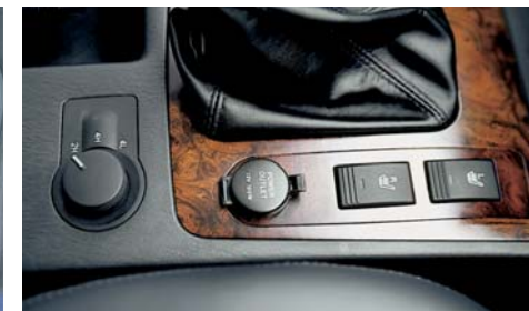
Ogrevanje sedežev, vtičnica za napajanje in priklopni štirikolesni pogon ter reduktor.
