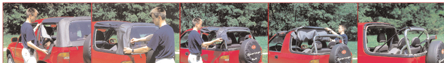
Snemanje strehe: snamemo obe stranici, odstranimo zadnje okno, sprostimo zadnja »stebrička«, odstranimo platno. Voilà!
