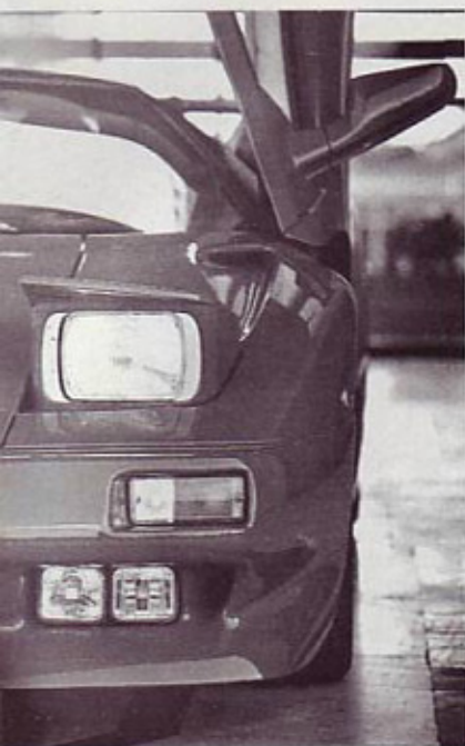
Od zgoraj navzdol: pogre- zljiv žaromet; pozicijska luč in utripalka; meglenki
