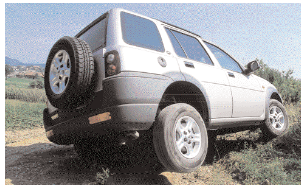
Ker ni zapor diferenciala, se kolo vrti v prazno.
