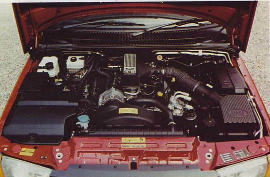
ličic je pet. Bencinska stroja sta osemvaljnika V-oblike s 4,0 in s 4,6 litri gibne prostornine, oba načelno že znana pri tej avtomobilski hiši, a tokrat podrobno na novo obdelana. Spremenili so jima ročične gredi, bate, ojnice, odmične gredi, bloka v celiem, izpušna sistema ter dodali novo, družno z Lucasom zasnovano elektroniko. Turbodizel je iz Münchna, torej Beemve-
