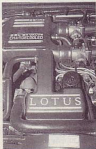
Lotusov motor s 377 KM in dvema turbinskima polnilnikoma.
