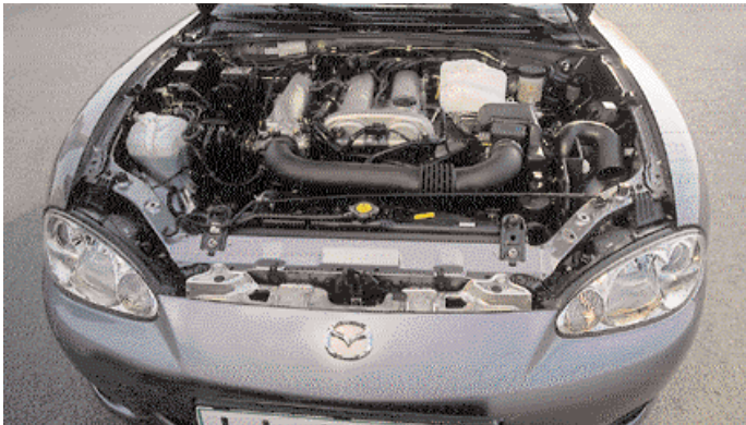
1,6-litrski motor s 110 KM: dovolj poskočen, a hkrati tudi (pre)glasen pri visokih vrtljajih.
