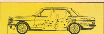
NOTRAŽNJE MERE (prednja sedeža v zadnji legi) v cm: širina pri kolenskih srednjem 148, zadaj 148; širina prednjega sedeža 55, zadnje kolen 147; notranja dožnja od armaturne plošče do zadnjega naslonjaka 175, pomik prednjega sedeža 14. Uporabna prostornina prtljajnika (merjeno s kockami) 490 dm 3
