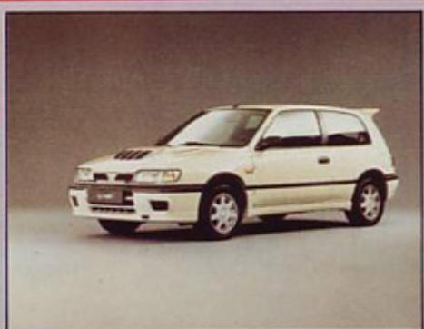
*Med predstavitvijo v Nici smo videli tudi nissan sunny GTi-R. To je rallyjevski dirkalnik, pripravljen za homologacijo v skupini A ter opremljen s štirikolesnim pogonom in z dvoulitrskim motorjem s turbinskim polnilnikom garrett ter s hladilnikom polnilnega zraka. Največja moč: 162 kW/220 KM pri 6400/min; največji navor: 267 Nm pri 4800/min; največja hitrost: 223 km na uro; pospešek 0-100 km na uro v 5,2 sekunde.*
