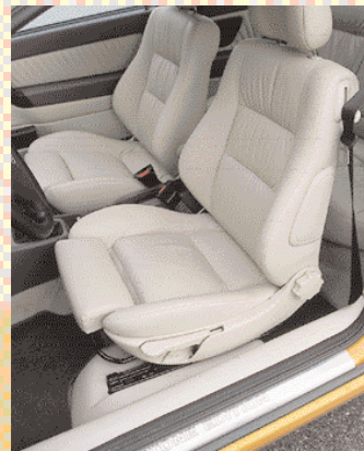
Odllična prednja sedeža omogočata tudi nastavitve dolžine sedalnega dela. Le nameščena sta previsoko!
