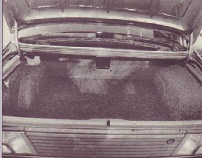
Prilježnik: uporabno pravih oblik in s premehkimi vzmetmi, ki podpirajo pokrov.
