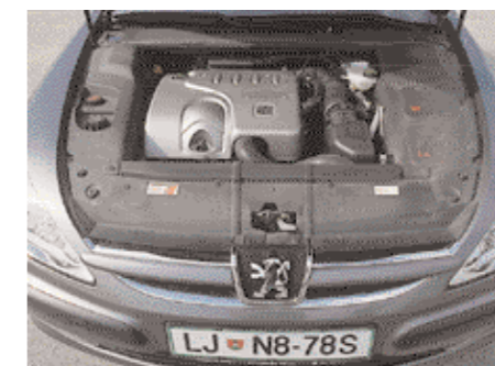
Varčen, v prostem teku rahlo tresoč (kljub vgrajenim izravnalnim gredem) in z dizelsko naravo delovanja: agregat 2.2 HDi
