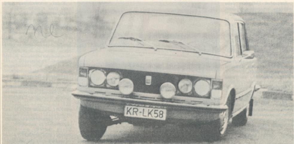
1,5-litrski motor, 75 KM, največja hitrost 144 km na uro. 125 P je mešanec med starim fiatom 1500 (motor in podvozje) in fiatom 125 (karoserija). Od leta 1968 ga izdelujejo skoraj nespremenjenega.
