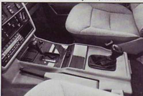
Komandni most: avtomatika v menjalniku, reduktor
