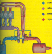
Motor, ki je v osnovi enak kot manjši motor renaulta 18 (1,4 litra, 64 KM), s pomočjo turbinskega polnilnika pri serijskem »5 turbo« zmore kar 160 KM pri 6000/min.
