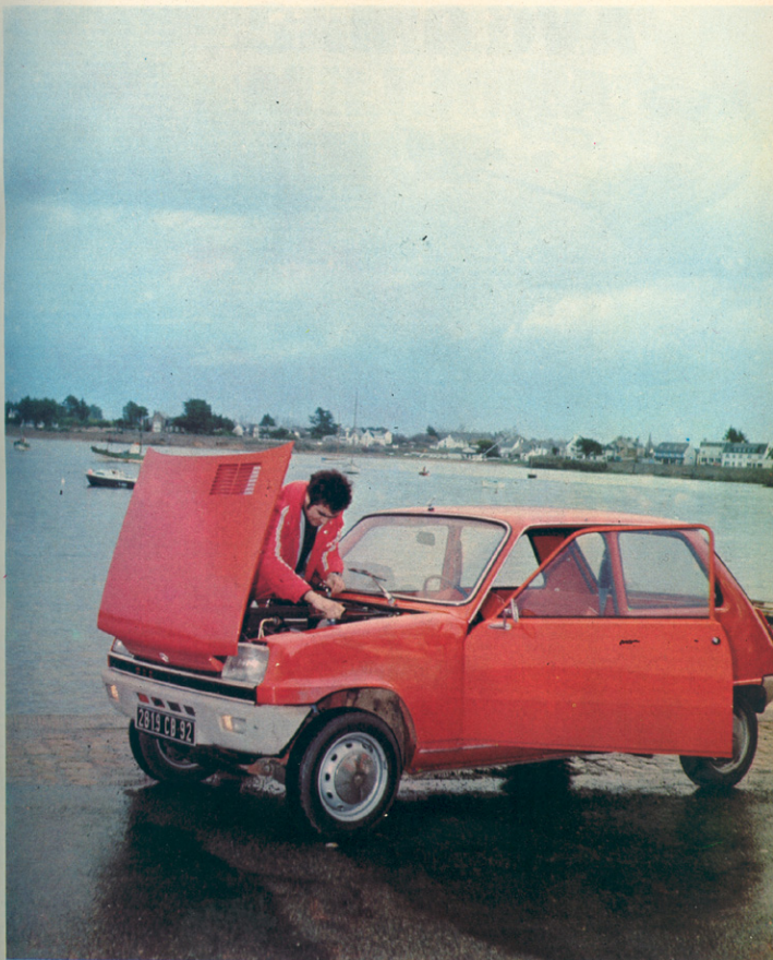
Renault 5 kljub zunanji dolžini (3,5 m) v notranjosti ni majhen. Tretja vrata na zadku skrivajo spremenljivi prtljažnik kot v R 4, R 6 in 16. Odbijači iz plastične mase armirane s steklenimi vlakni so kot pri R 15/17. Prenesejo trčenja do 7 km na uro. Pomična streha je na voljo za doplačilo.
