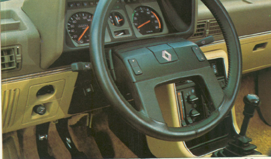
Zelo popolna armaturna plošča »9 TSE«; slabše opremljene devetke med drugim nimajo merilnikov vrtljajev in količine olja v motorju
