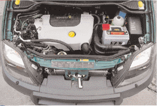
Sodoben dizelski motor se odkupi predvsem z navorom in majhno porabo.
