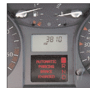
Samodejna elektronsko krmiljena mehanska zavora je le delno samodejna. Med postanki na semaforju jo je treba ročno »zategniti«. Sprostí se ob prvem pritisku na plin.
