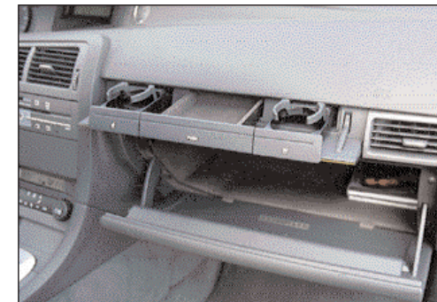
Držali za pijačo in majhen predalček so domiselno skriti za »leseno« letvico na sovoznikovi strani armaturne plošče. Spodnji predal je dovolj bogatih izmer in hlajen.
