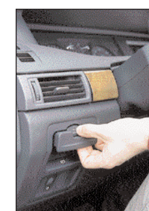
Samodejna elektronsko krmiljena mehanska zavora je le delno samodejna. Med postanki na semaforju jo je treba ročno »zategniti«. Sprostí se ob prvem pritisku na plin.
