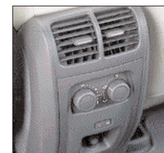
Tudi na zadnje potnike niso pozabili. Ločen ventilator skrbi za dovod svežega zraka tudi na zadnji klopi.
