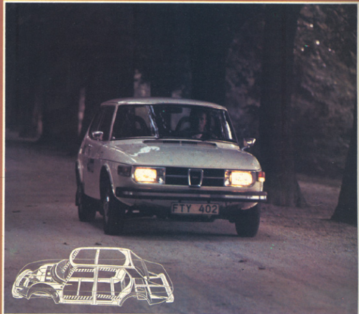
Prijetnejša gipnata karoserija je glavni adut varnosti v rokah saabovih inženirjev. Črtkano označene so opore v prednjih nosilnih in okrepiteve na bokih.
