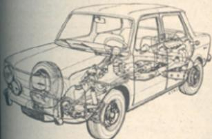
Rentgenska slika med drugim tudi natanko razkriva namestev hladilnika za vodo v nosu. Hladilni zrak dobiva skozi lovnilnik zraka pod karoserijo, potem pa mu pomaga električni ventilator s termostatskim vključkom.
