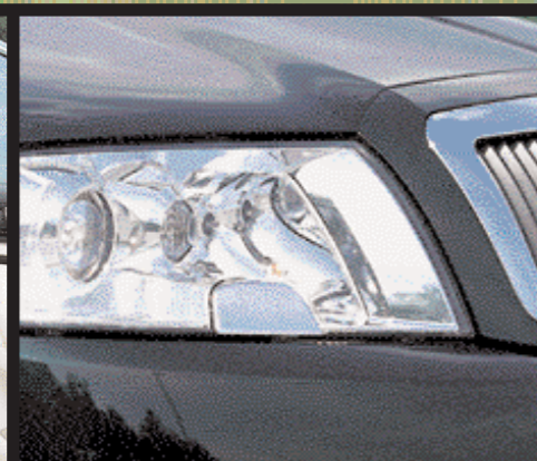
Kromiran dodatek skriva sistem za pranje žarometov. To sodi med dodatno opremo, ki je testni avtomobil ni imel.
