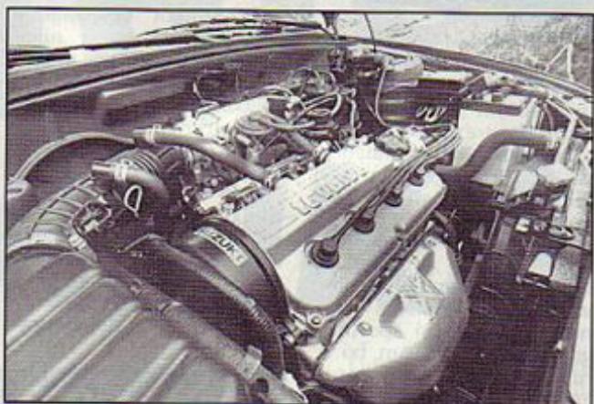
Japonska poskočnost s po štirimi ventili na valj
