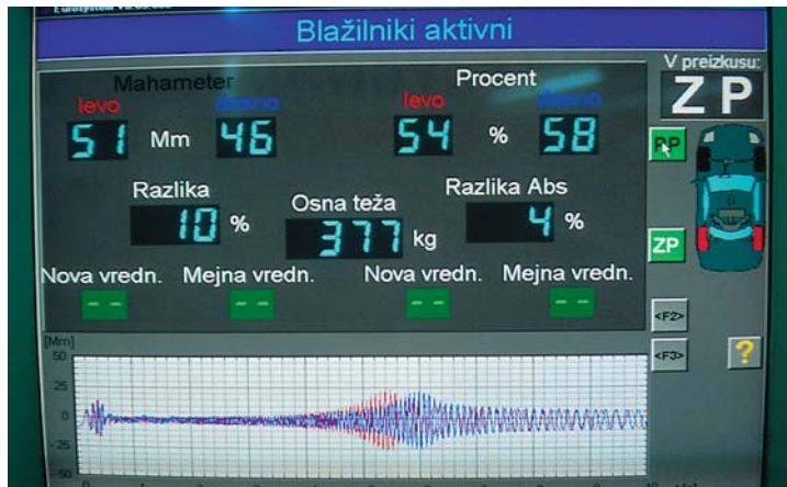
Na tehničnem pregledu ni bilo težav. Zadnji blažilniki so sicer kazali napore, ki jih je v 100.000 km doživel Yaris, a zamenjava še ni bila potrebna.
