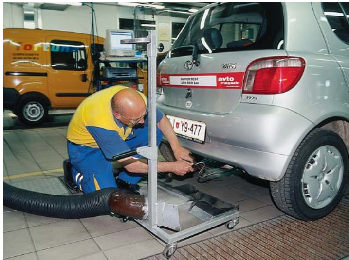
Na tehničnem pregledu ni bilo težav. Zadnji blažilniki so sicer kazali napore, ki jih je v 100.000 km doživel Yaris, a zamenjava še ni bila potrebna.
