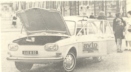
Italijanski krojač, ki je za nemške naročnike oblikoval novi VW, iz karoserije ni mogel narediti lepota, zato pa je v predelgom nosu 400 litrov prostora za prtljago, »111« je prvi VW s štirimi vrati (po želji).
