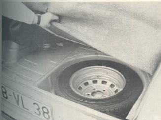
Rezervno kolo v dnu prtljažnika zagotavlja velik prostor za prtljago. Manj je taka namestitve prijetna, ko gre za zamenjavo kolesa.
